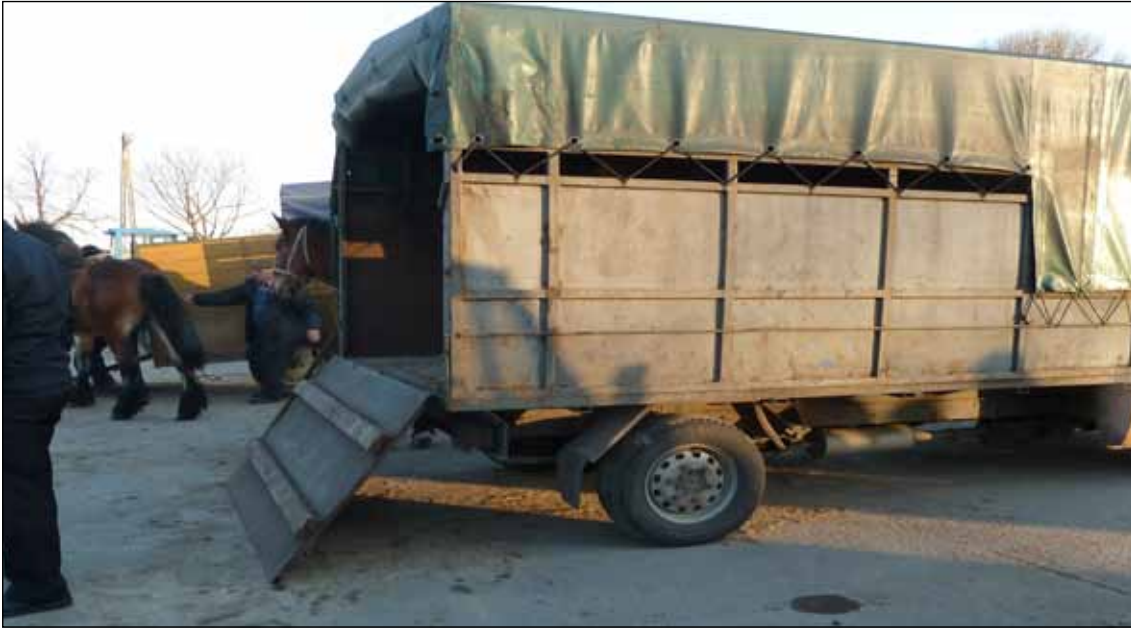
BODZENTYN, 22.04.2013: Steep ramp without lateral protection.
