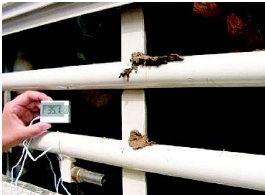
Temperaturmessung in einem Transporter auf der Fähre von Italien nach Griechenland
